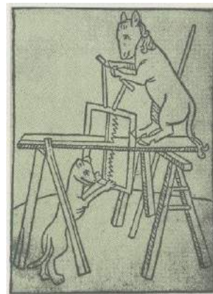
Figur 8: Træsnit fra slutningen af 1400-årene. Kløvsavning med ramsav. Kilde: Pjecen 'Træ: fra Skov til Brug', 1975, Træbranchens Oplysningsråd.
