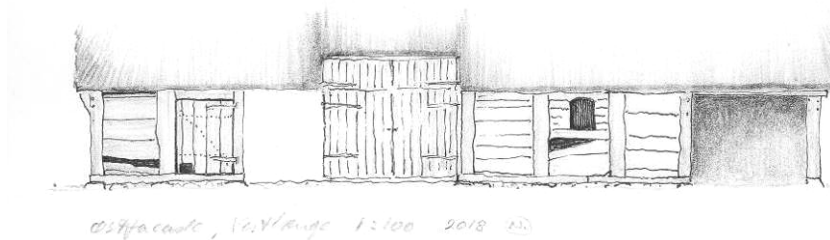
Figur 87: Registreringsblad, eksisterende forhold. Skitsenotat vestlængen, østfacade, Døren i østfacadens sydlige ende er en revledør med skrårevle (forsidebilledet). Revlerne er udført i egetræ, dørplankerne er udført i brede fyrrematerialer. Plankerne er fæstede til revlerne med i borede trænagler med hoveder. De gennemgående nagler er 'låst' med træpløkke, der er boret igennem på tværs af naglernes spidser. Udvendig har dørfløjen farvespor af en oxydrød farve. Farvesporene kan ses under en del af naglehovederne på ydersiden. Gengivet i målestok 1:200.
