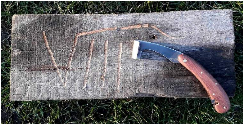
Figur 41: Romertal VIII med fane udført med moderne ridsekniv. Forsøg med tømmernummerering på egeklods, for at eftervise hvilket redskab der er anvendt på stortømmerkonstruktioner og bulfjæle i Ørby 20.
