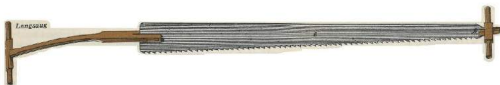
Figur 9: Langsavg, også kaldet kløvsav. Den viste sav er fra 1800-tallet, men typen er kendt siden begyndelsen af 1500-tallet. Kilde: Pjecen 'Træskibet', 1968, udgivet af Træbranchens Oplysningsråd.
