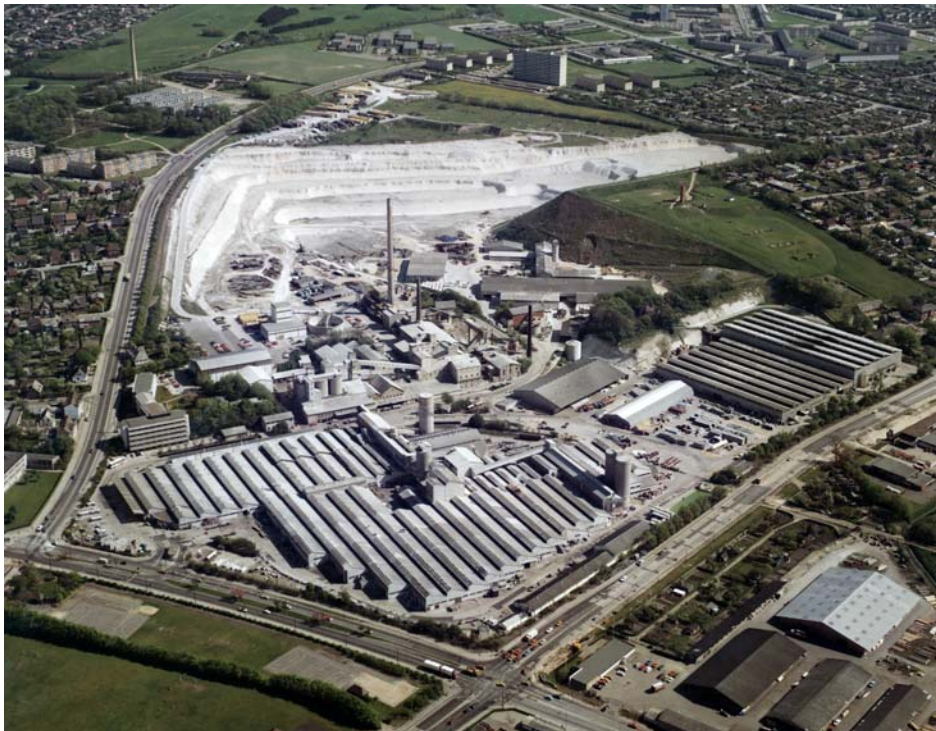
Figur 44. Luftfoto af Dansk Eternit Fabrik o. 1970. Nederst ses den meget store bygningsmasse, hvor der fra 1934 til 2003 har været produceret især eternitplader. I midten resterne af cementfabrikken Danmark, og øverst til højre hallerne, der har rummet siporexfabrikken. I baggrunden cementfabrikkens kridtbrud. Kilde ukendt.
