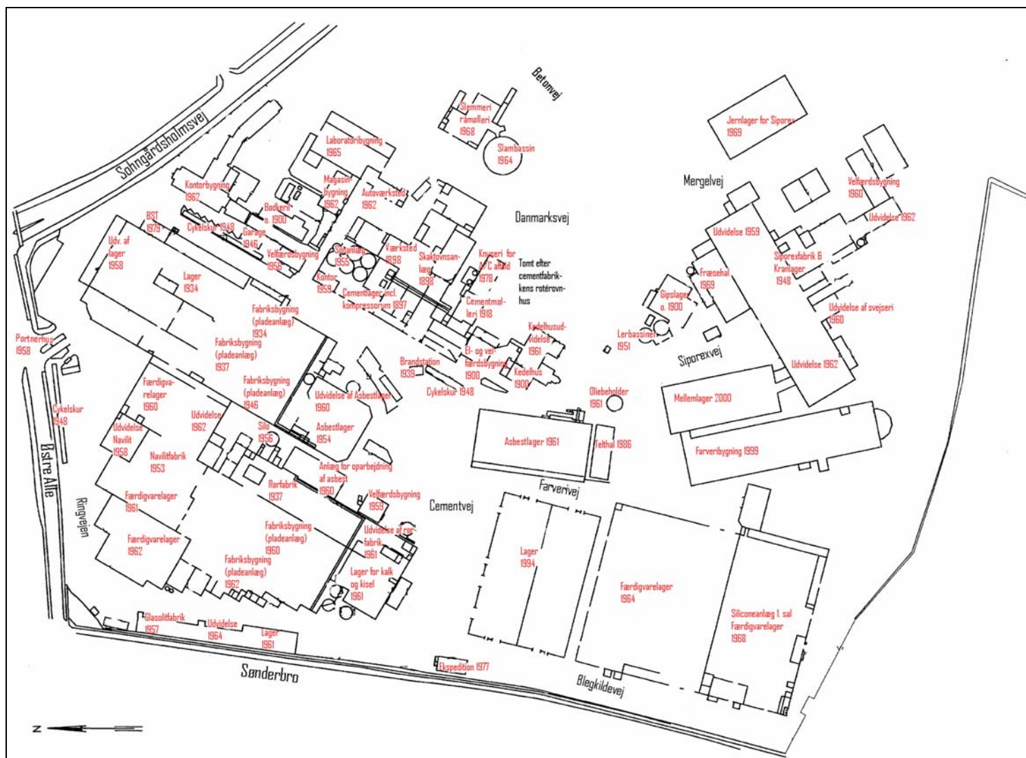
Figur 48. Rids over bygningsmassens udvikling med en række bygningsdateringer, angivelser af bygningernes oprindelige formål og en række vejnavne. Illustration Morten Pedersen.
