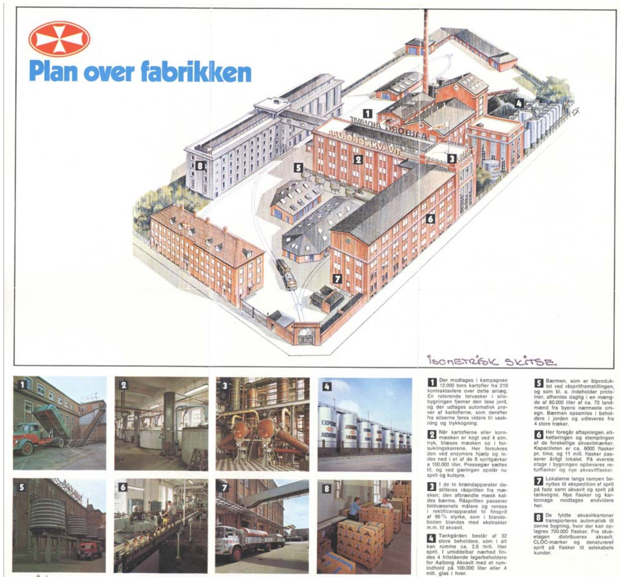
Figur 27. Skitse over spritfabrikkens bygningsmasse og dens anvendelse ved industriregistreringen i slutningen af 1970'erne. Der er foretaget enkelte ændringer i anlægget, bl.a. foregår tapningen ikke længere i bygningen længst mod vest og administrationsbygningen mod Strandvejen er udlejet. Størsteparten af produktionsprocessen er dog placeret i de samme lokaler som ved opførelsen i 1931 – og i flere tilfælde i de samme anlæg. Reklamemateriale fra fabrikkens.
