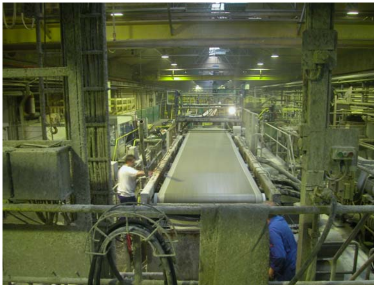
Figur 55. Blik hen over eternitpladeproduktionen i det tidligere siporex-kranlager. 2004. Foto Morten Pedersen.
