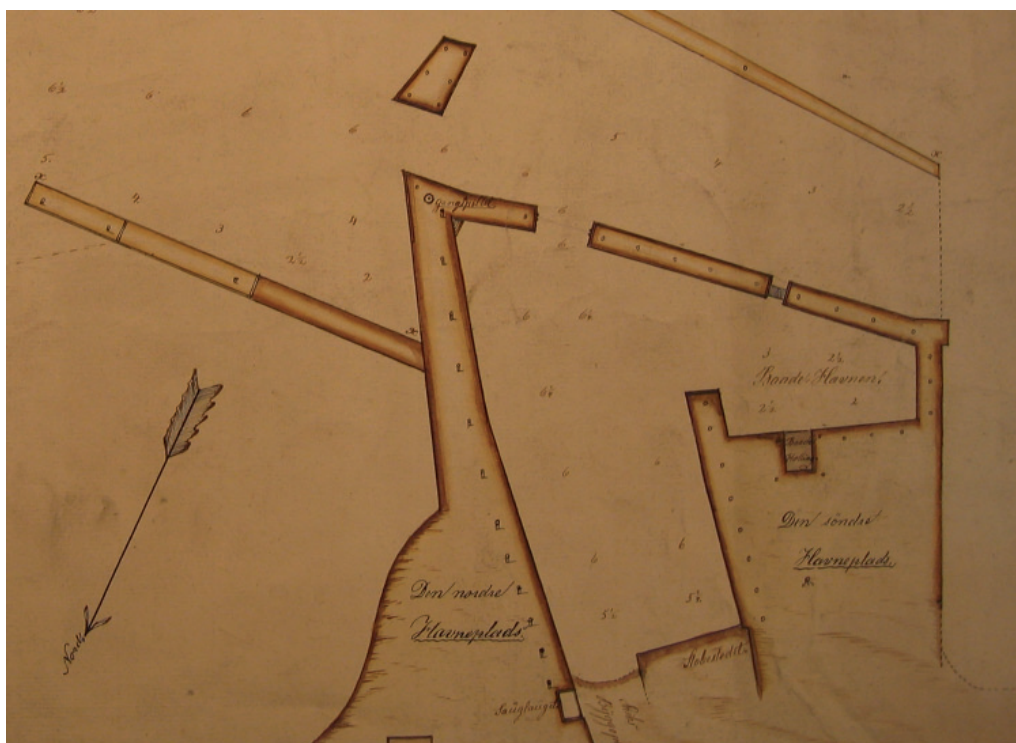
Nexø Havn 1839, stærkt beskåret plan. På moleknæet øverst er opstillet et gangspil. I havnens sydlige del findes et åbent skibsbyggeri ved en ophalerbedding, et savlaug samt som havnens eneste bygning, et lille koge- og materialhus (Rigsarkivet, Kort- og Tegningssamlingen).
